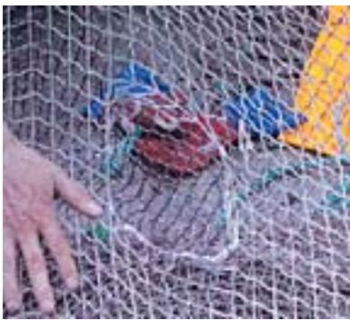
Figur 38: Typisk hull etter besøk av sel (steinkobbe?)
