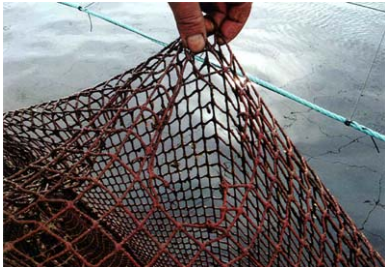
Figur 37: Hull i not. Not er impregnert hos notverksted etter at hullet er oppstått, snittflatene er impregnerte
