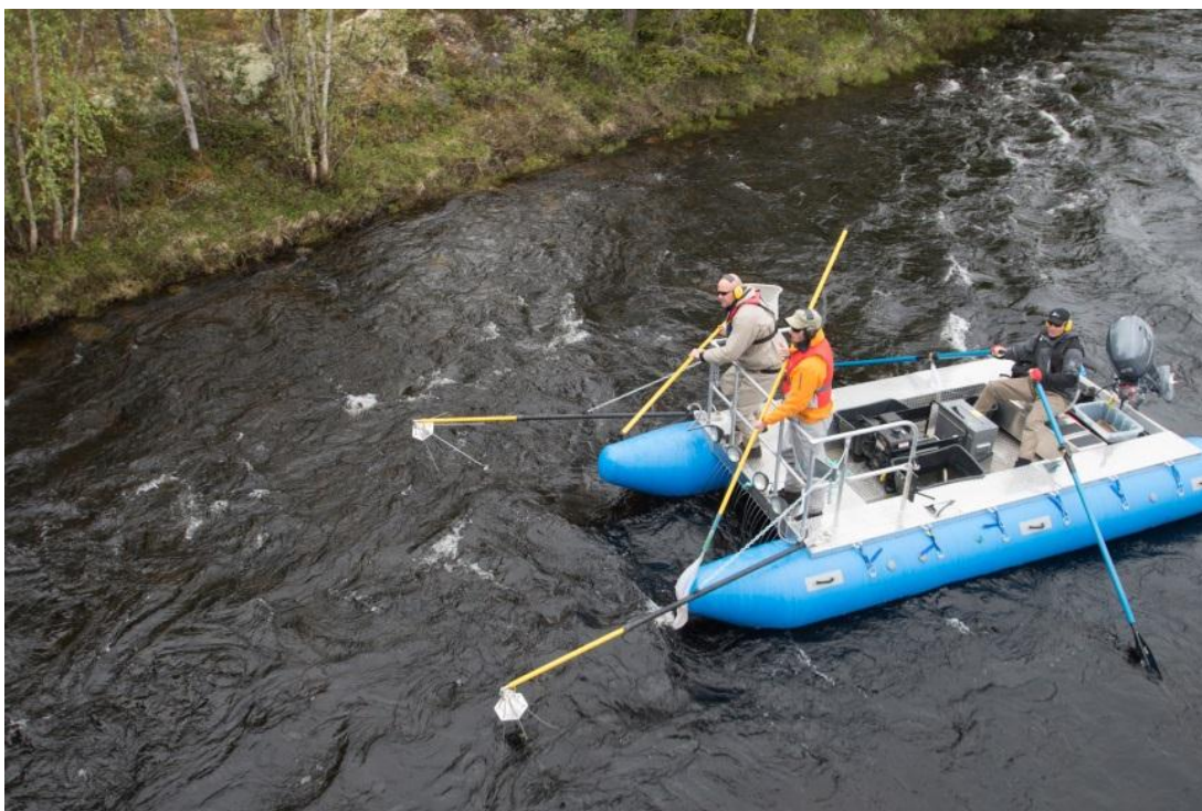
Figur 14. Øverst: Den største av elfiskebåtene til NINA. Model 18 EH med 200 hk vannjetmotor (foto: Jon Museth). Nederst: Elfiskebåt av typen CATARAFT som er tilpasset bruk i strømssterke og grunne elver (Foto: B. K. Dervo).
