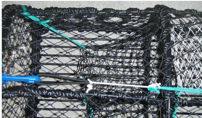
Figur 3. Bomullstråd mellom strikk og låsekrok.
