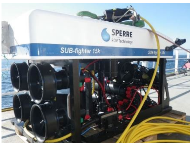
Figur 7. ROV brukt under toktet, en Sperre SUB fighter 15k
