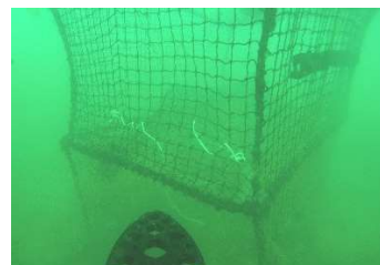
Bilde 26. Viser røm.hull på kortside med simulert trådbrudd
