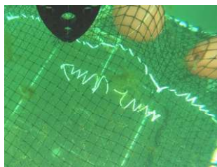
Bilde 24. Viser røm.hull i tak med simulert trådbrudd
