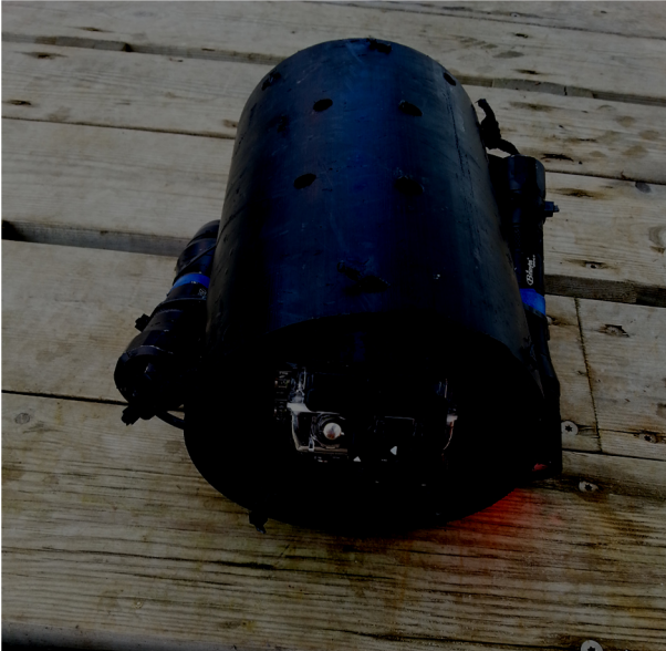
Fig. 3. Videoenheten med lys og GoPro-kamera.
