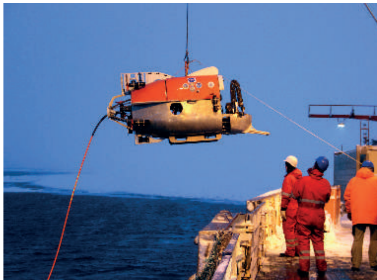
Abb. 1.5: Das Nereid Under Ice (NUI) des Woods Hole Oceanographic Institute (WHOI USA) ist mit einem haarfeinen Glasfaserkabel mit dem Schiff verbunden und überträgt hochauflösende Bilder sowie Multibeam Daten und Sensoren Messungen vom Meeresboden bis zu 1000 m unter dem Eis.
